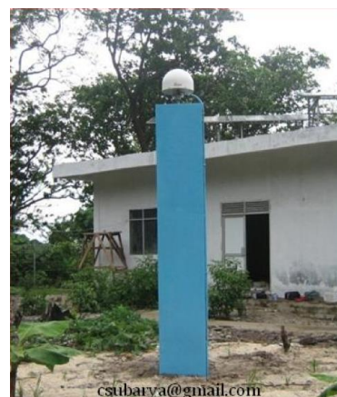
Gambar IV-5. Contoh pilar GPS kontinu milik BIG: titik CSGT di Sagaranten (kiri), titik CUJG di Ujung Kulon (kanan)
